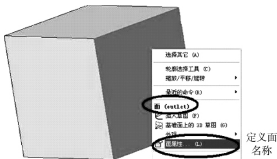
图 3 在 solidworks 中定义面名称(outlet)
